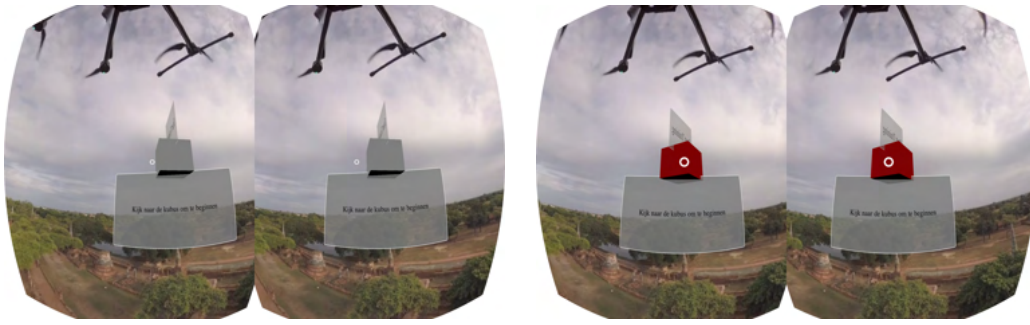
Figuur 4.8: Het proces van een object selecteren via gaze to pick . Wanneer de gebruiker gedurende een bepaalde tijd naar een object kijkt, wordt deze geselecteerd.
